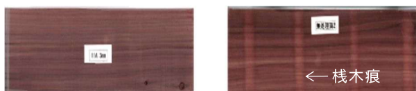
図2 栈木痕の発生状況 (左:工夫栈木あり 右:工夫栈木なし)
