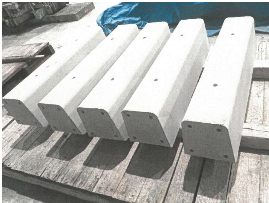
火山ガラス微粉末(Volcanic Glass Powder)を用いた コンクリートで製作した歩道の縁石
