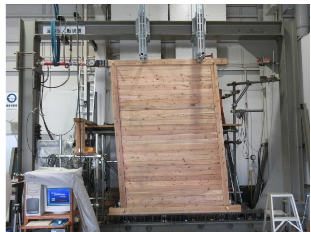
Jログ工法耐力壁の面内せん断試験
