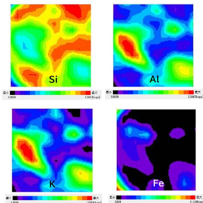
蛍光X線分析装置を用いた岩石試料のポイント・マッピング分析結果
