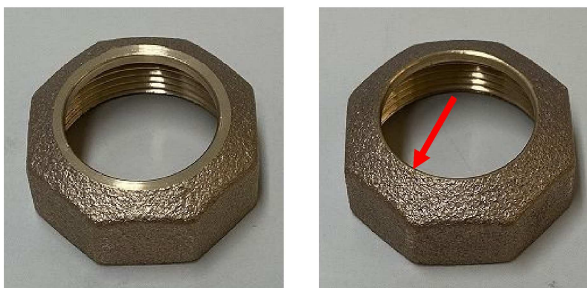
a) 正常 b) 不良 図14 切削面が形成されない例
