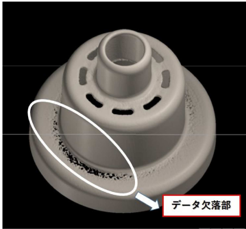
図11 供試材2のデータが欠落した画像
